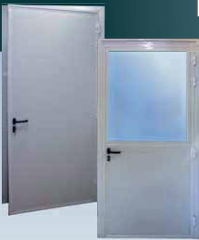
Portes semi-isolées pour bureaux et locaux en température positive. Simple ou double battant, en mousse de polyuréthane injecté haute densité (40 Kg/m<sup>3</sup>) entre deux parements de tôle d'acier laqué blanc, revêtue d'un film protecteur pelable.
